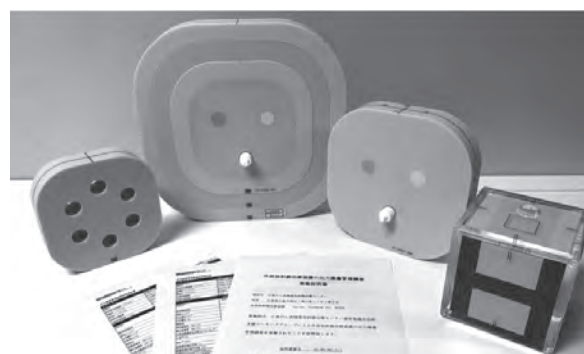
図2 技術支援WGで開発した第三者評価用各種ファントム(TG-2及びTG-4)とTG-1の結果報告書。
