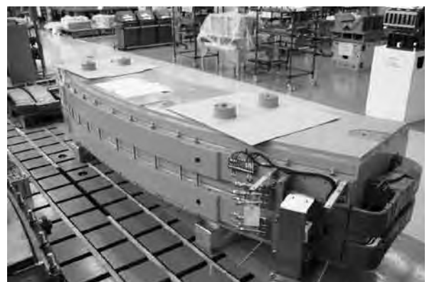
図3. 工場で作成中の45°偏向電磁石 (高エネルギービーム輸送系)
